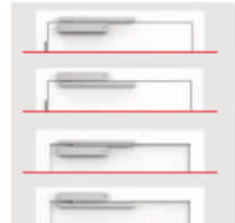
rechts oder links Bandseite oder Bandgegenseite Sturz oder Türblattmontage. Ein Türschließer für alle Montagearten
