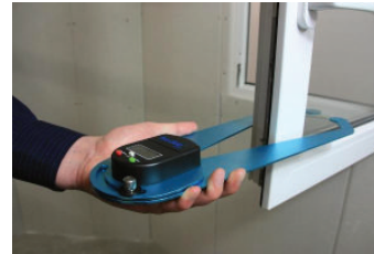
Einfaches Umgreifen von Türzarge oder Fensterrahmen zur Bestimmung von Wandstärken oder Glasdicken
